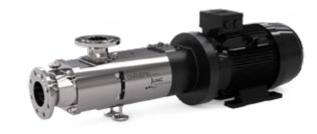
Die CHEMSPIN Pumpenbaureihe wird aus hochwertigem, austenitischem Edelstahl in der eigenen Fertigung hergestellt und unterliegt strengsten Qualitätskontrollen. Sie eignet sich für Medien von nahezu jeder Viskosität und kann einen Förderdruck bis 35 bar, in modifizierter Version auch Drücke bis 50 bar aufbauen.
