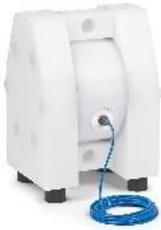
Im Falle eines Membranbruchs und dem Wegfall der Druckluft kann das Fördermedium durch den Druck des Prozessmediums in das Luftmotorgehäuse der Pumpe gelangen und ggf. am Schalldämpfer austreten. Dieser Flüssigkeitseinbruch lässt sich mit einer Membranbruchüberwachung detektieren.
