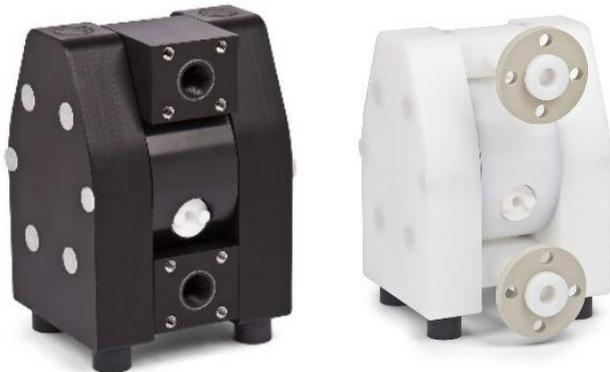
Diese Option ermöglicht Flanschanschlüsse nach verschiedenen DIN oder ANSI Flanschformen in unterschiedlichen Druckstufen. Die Edelstahl Gewindebuchsen (Code F1, F2, F3) zur Flanschbefestigung befinden sich im Blockflansch. Zur Abdichtung der Flanschverbindung sind die beigefügten O-Ringe in die Flanschnut einzulegen. Die Flansch O-Ringe bestehen aus EPDM (F1), NBR (F2) und FEP/FKM (F3).
