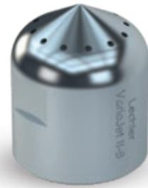
**Lechler VarioJet Düsen** zerstäuben nach dem Prinzip der inneren Mischung. Bei dieser Zweistoff-Düse wird das Wasser axial über eine Bohrung zugeführt.
