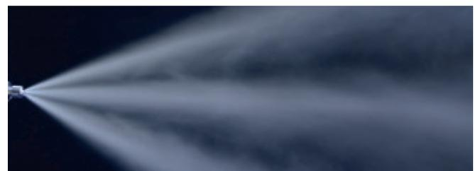
Sprühbild einer Flachstrahldüse
