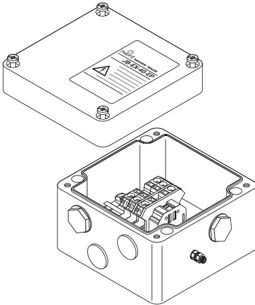
ATEX-zugelassener Anschlusskasten mit Erdungsplatte für den Einsatz in Ex-Bereichen. Dieser Anschlusskasten kann zur Verbindung zwischen Zuleitungen, Heizkabeln und Kaltleitern mit metallenen M25-Anschlussgarnituren oder -Verschraubungen verwendet werden. Die Verbindungen werden über die Erdungsplatte geerdet.
