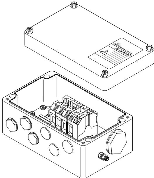
ATEX-zugelassener Anschlusskasten mit Erdungsplatte für den Einsatz in Ex-Bereichen. Dieser Anschlusskasten kann zur Verbindung zwischen Zuleitungen, Heizkabeln und Kaltleitern mit metallenen M25-Anschlussgarnituren oder -Verschraubungen verwendet werden. Die Verbindungen werden über die Erdungsplatte geerdet.
