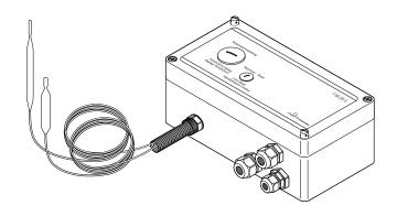
Dieser Thermostat eignet sich zur Temperaturüberwachung und -regelung von Beheizungssystemen im Nicht-Ex-Bereich. Der Begrenzer verhindert, dass das Heizsystem eine voreingestellte Höchsttemperatur überschreitet, falls der Thermostat ausfällt oder eine sicherheitsgefährdende Prozesstemperatur auftritt.
