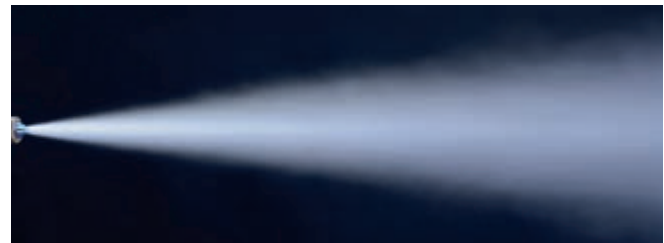
Sprühbild einer Laval-Düse
