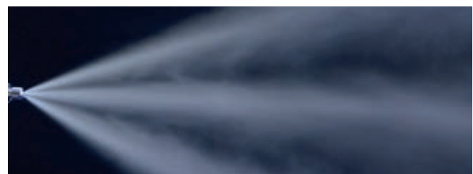
Sprühbild einer Flachstrahldüse
