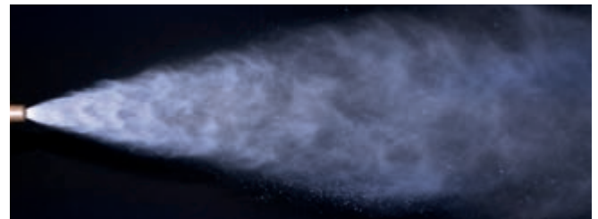
Sprühbild einer MasterNOx®-Düse 30°
