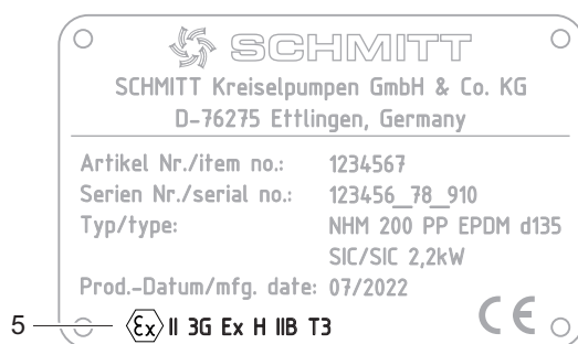
Abb. 2 Typenschild ATEX (Beispiel)
