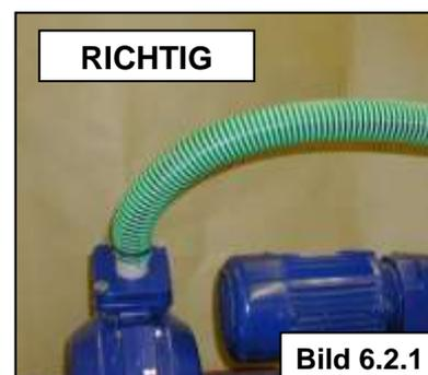
Der Anschluss erfolgt standardmäßig mit flexiblem Schlauch und Schlauchschellen, bei Sonderausführungen über Getränkerohrverschraubung, Kamlok-Kupplung, Normflansch etc.
