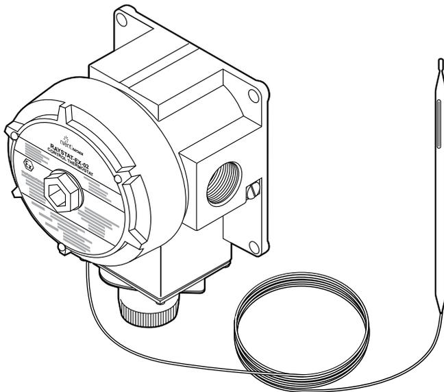
Dieser nach EEx d zugelassene Thermostat kann mit allen Heizleitungen vom Typ nVent RAYCHEM BTV, QTVR, KTV, VPL und XTV in Ex-Bereichen eingesetzt werden. Die Schalttemperatur kann an einem geschützten, externen Drehknopf zwischen  $-4^{\circ}\text{C}$  und  $+163^{\circ}\text{C}$  eingestellt werden.
