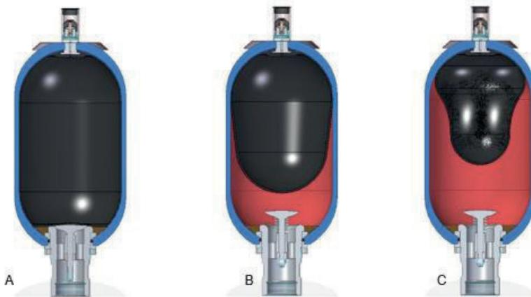
**A.** Die Blase ist in der Vorfülldruckstellung, d.h. sie ist nur mit Stickstoff  $P_0$  beaufschlagt. Das Ölventil ist geschlossen und verhindert die Zerstörung der Blase.
