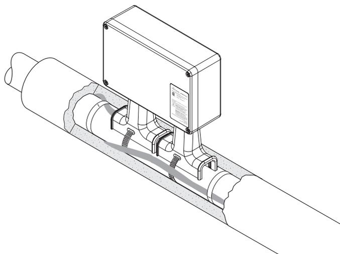
Die Anschlussgarnitur nVent RAYCHEM JB-SPLICE-PI-E ist für den direkten Anschluss industrieller Heizkabel der nVent RAYCHEM XPI-Reihe an eine Stromquelle vorgesehen, ohne Verwendung von Kaltleitern. Es gelten bestimmte Beschränkungen hinsichtlich Spannung und Stromstärke.
