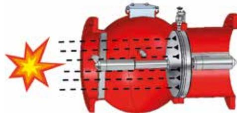
Im Explosionsfall schließt das Ventil selbsttätig durch die kinetische Energie der Druckwelle, die der Flammenfront vorausseilt. Dabei taucht der Schließkörper axial in den Rohrleitungskörper des Ventils ein und wird über eine Verriegelungseinrichtung flammen-durchschlagsicher arretiert. Der geschlossene Zustand des Ventils kann über elektrische Signalgeber angezeigt werden.
