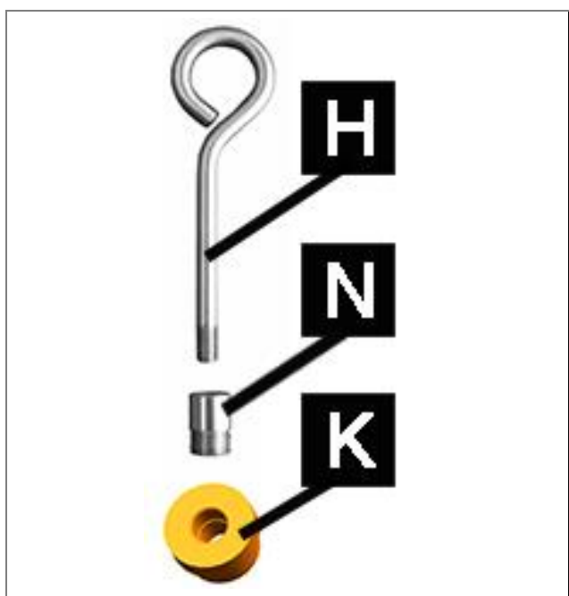
Abb. 12: Austausch der Plungerabdichtung HP32-12
