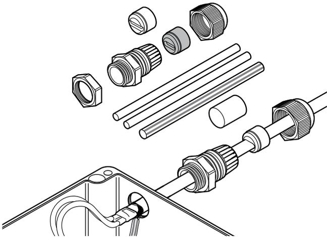
Diese Anschlussgarnitur ermöglicht den Anschluss der Heizbänder vom Typ nVent RAYCHEM BTV, QTVR, XTV, KTV und VPL an einen der Anwendung entsprechenden Anschlusskasten.
