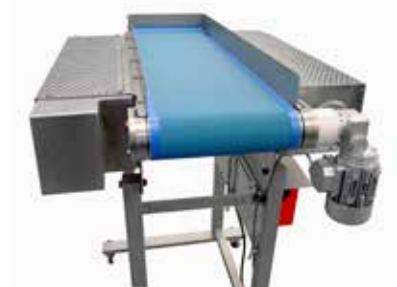
Trocknungsband mit Ventilatoren
