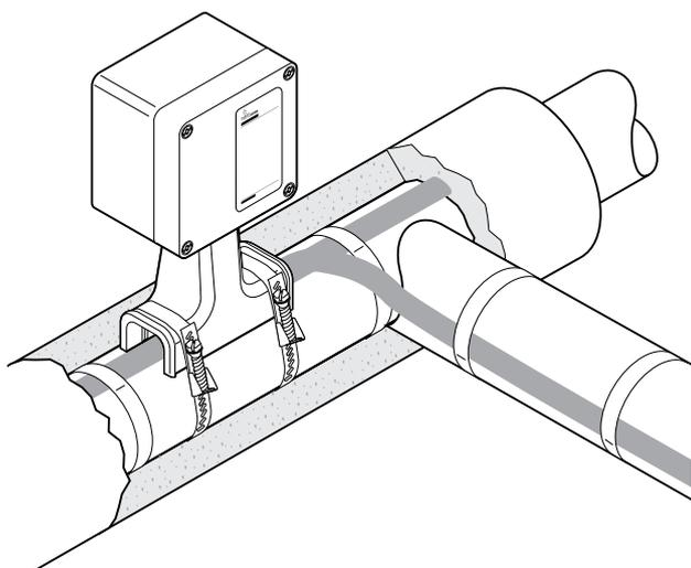
Der Anschlusskasten nVent RAYCHEM T-100 für Verbindungen und T-Abzweige wurde für die elektrische Verbindung von bis zu drei Heizbändern des Typs nVent RAYCHEM BTV, QTVR, XTV, KTV oder VPL entwickelt. Er ist für den Einsatz in Ex-Bereichen freigegeben.
