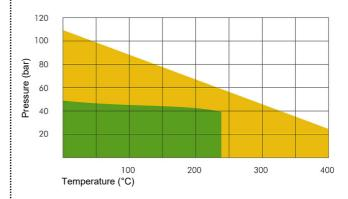
Das P x T Diagramm gibt den möglichen Einsatzbereich der Type **NA-1005** in Bezug auf Druck- und Temperaturverhältnisse an. Der grüne Bereich entspricht dem
