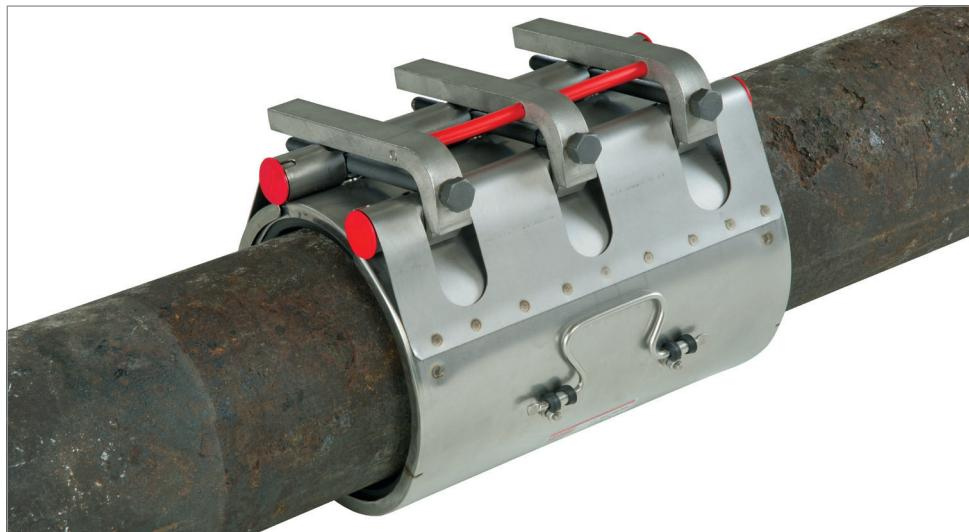
**STRAUB-REP-FLEX** Reparaturkupplungen dienen der sicheren Reparatur von Leitungsbrüchen und der Abdichtung von Korrosionsschäden an Trink- und Wasserleitungen. Das bewährte STRAUB Dichtlippensystem sorgt für einen zuverlässigen und dauerhaften Einsatz auf Rohren verschiedenster Materialien wie Stahl, Guss, Duktiguss, Faserzement, PVC oder PE.
