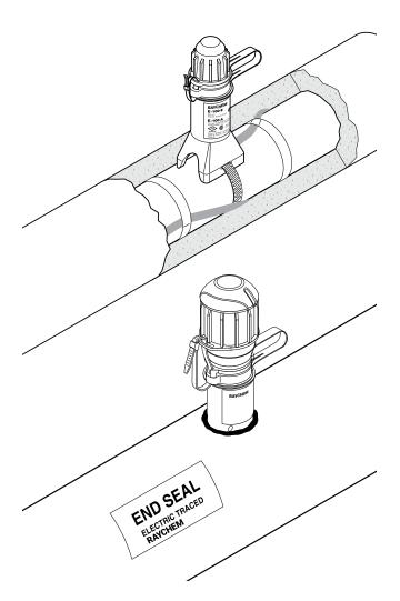
Die Endabschlüsse nVent RAYCHEM E-100-E und E-100-L-E sind leicht zugänglich und wiederverwendbar. Der E-100-L ist zusätzlich mit einer Kontrollleuchte ausgestattet. Beide Abschlüsse eignen sich für alle Heizbänder des Typs nVent RAYCHEM BTV, QTVR, XTV, KTV und VPL. Die Anschlussgarnituren sind für den Einsatz in Ex-Bereichen freigegeben. Hochfeste Gussteile mit einer Wandstärke von 4 mm machen sie extrem widerstandsfähig.
