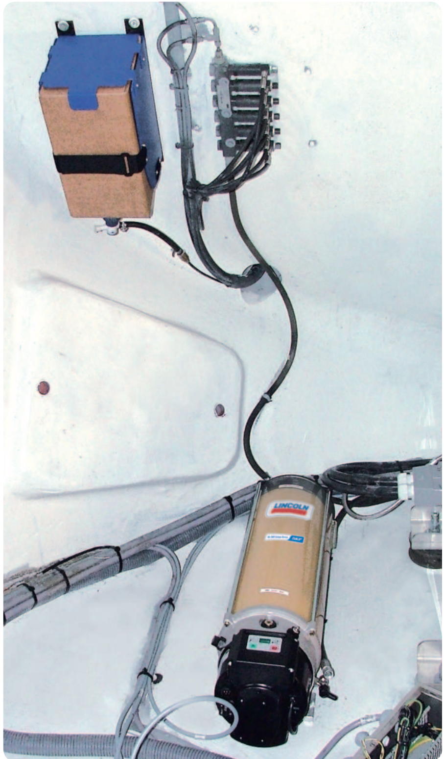
603S-Schmiersystem mit SE1-Absaugelementen und Altfett-Auffangbehälter
