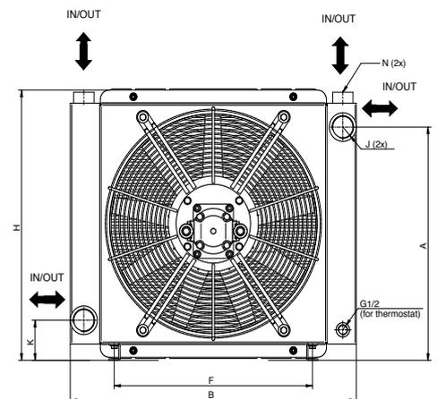
Neuentwicklung: Die Flex-Baureihe => mit Ein- und Ausgängen nach oben und nach vorne/hinten, für besonders flexible Anschlußmöglichkeiten!
