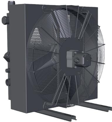
Diese Kühlertyp mit Hydraulikmotor ist für stationäre und Mobilanwendungen konzipiert und dient vor allem zur Kühlung von unterschiedlichen Ölen (Hydraulik, Schmierung,...) und Wasser/Glycol Mischungen (> 15 % Glycol). Das mögliche Schluckvolumen der Motoren reicht von 4 cm<sup>3</sup> bis 45 cm<sup>3</sup>. Ausführungen inkl. diverser Zubehör und als 1-Pass, 2-Pass oder 3-Pass möglich.
