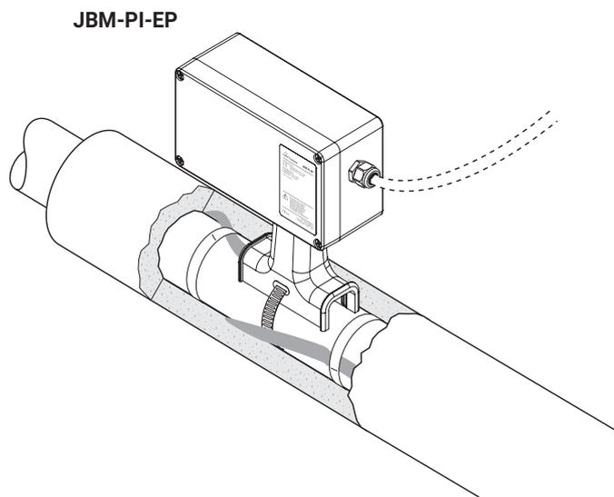
Die Anschlussgarnitur nVent RAYCHEM JBM-PI-EP ist für den direkten Anschluss industrieller Heizkabel der nVent RAYCHEM XPI-Reihe an eine Stromquelle vorgesehen, ohne Verwendung von Kaltleitern. Es gelten bestimmte Beschränkungen hinsichtlich Spannung und Stromstärke.
