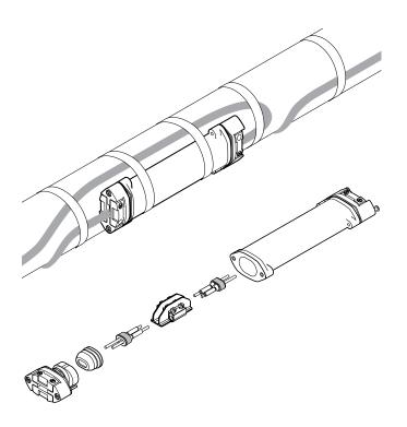
nVent RAYCHEM S-150 ist eine Flachprofil-Verbindungs-garnitur in Kaltanschlusstechnik. Diese universelle Garnitur passt für alle Heizbänder vom Typ nVent RAYCHEM BTV, QTVR, XTV und KTV. Dies ermöglicht eine vereinfachte Produktauswahl und eine reduzierte Lagerhaltung. Die Garnitur kann für Anwendungen im Temperaturbereich von –50 °C bis +215 °C eingesetzt werden und ist für die Verwendung im Ex-Bereich zugelassen.
