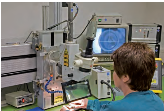
Heißlötstelle bei MTE mit einem Thermopaar Hot junction for MIT with one thermocouple
