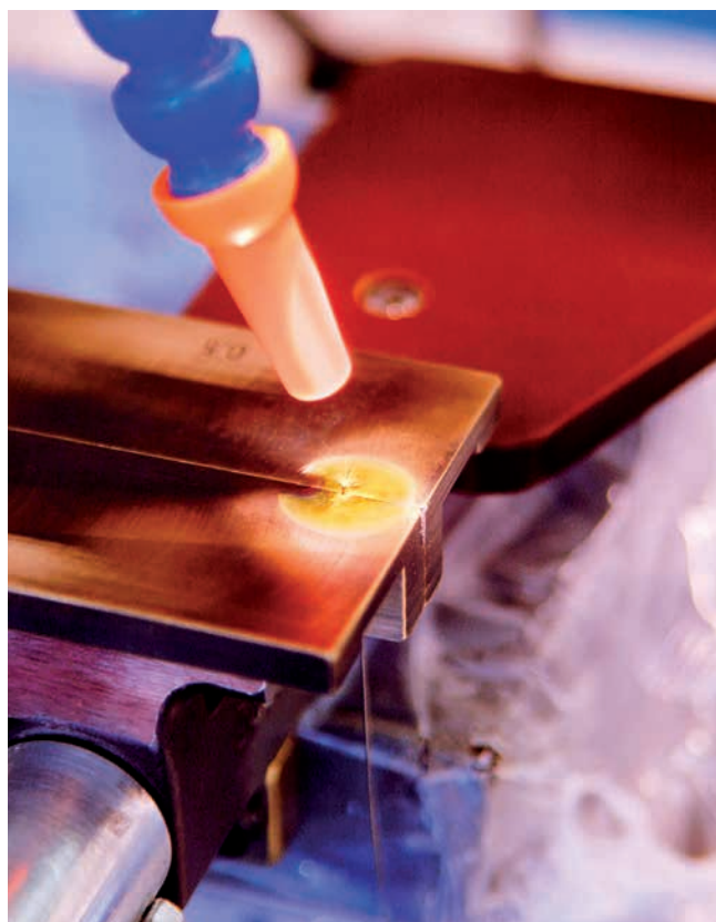
Verschließen der Heißlötstelle eines MTE Welding of a MIT's hot junction
