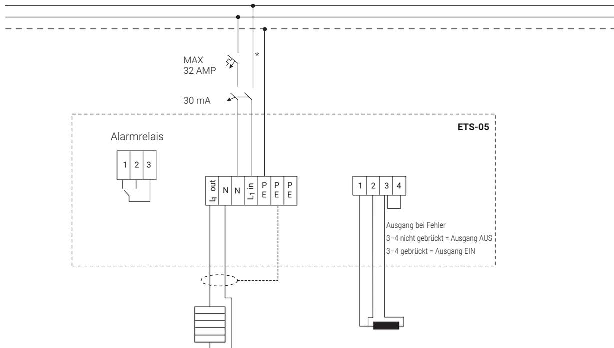
\* Die Ausführung des Leitungsschutzschalters kann den örtlichen Normen/Anforderungen entsprechend variieren.
