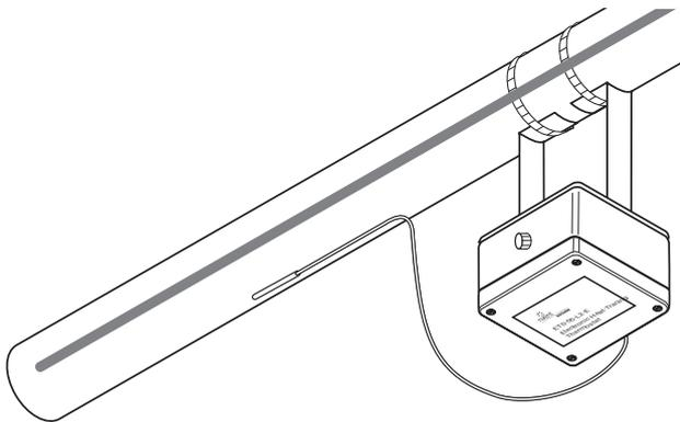
Der nVent RAYCHEM ETS-05 ist ein elektronischer Thermostat mit Anlege- und Umgebungstemperaturfühler zur präzisen Temperaturregelung von Heizleitungen.
